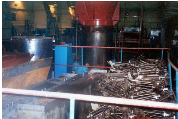
Небрежное хранение подвесок перед установкой на пенал с ядерным топливом.
