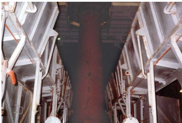
Вагон-контейнер для перевозки ОЯТ. На снимке хорошо видна коррозия металла кузова вагона и его деталей.
