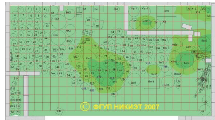
После 2 этапа локализации источников, осень 2007, \bar{P}_2 = 0,34 мЗв/ч
