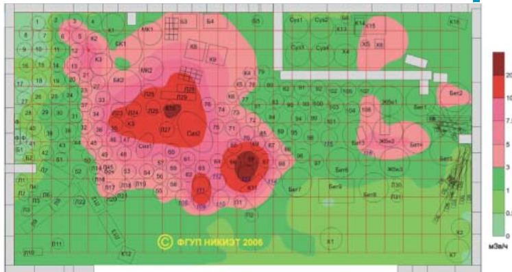
До локализации источников, весна 2006, \bar{P}_1 = 3,21 мЗв/ч
