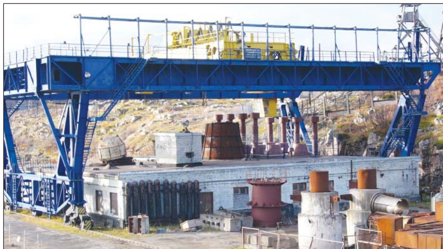
Здание 1Б. Мостовой кран 75/20 т оснащен системой OSMOS
